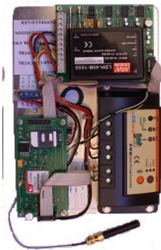
ELIOS\_S1 è composto essenzialmente da una scheda microcontroller, una scheda di comunicazione, di una scheda alimentatore per il led e di un controllore di carica delle batterie.
