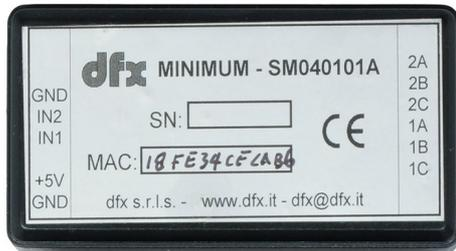
Il modulo per ingressi e uscite digitali consente il comando a distanza di apparecchi che, tipicamente, possono essere attivati da un interruttore. Questa funzione viene svolta dai due relay di cui il modulo è dotato, che possono quindi controllare due diversi apparecchi.
